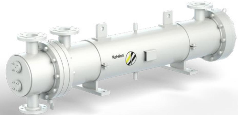
Wenn das Standardmodell die Anforderungen Ihrer Anwendungen an Größe, Leistung oder Konstruktion nicht erfüllen kann, ist unsere Advanced-Serie die perfekte Wahl. Diese Wärmetauscher sind ausgelegt für Temperaturen von -29 °C bis 400 °C und Drücke von bis zu 60 bar (g) auf der Mantelseite und bis zu 40 bar (g) auf der Rohrseite.
