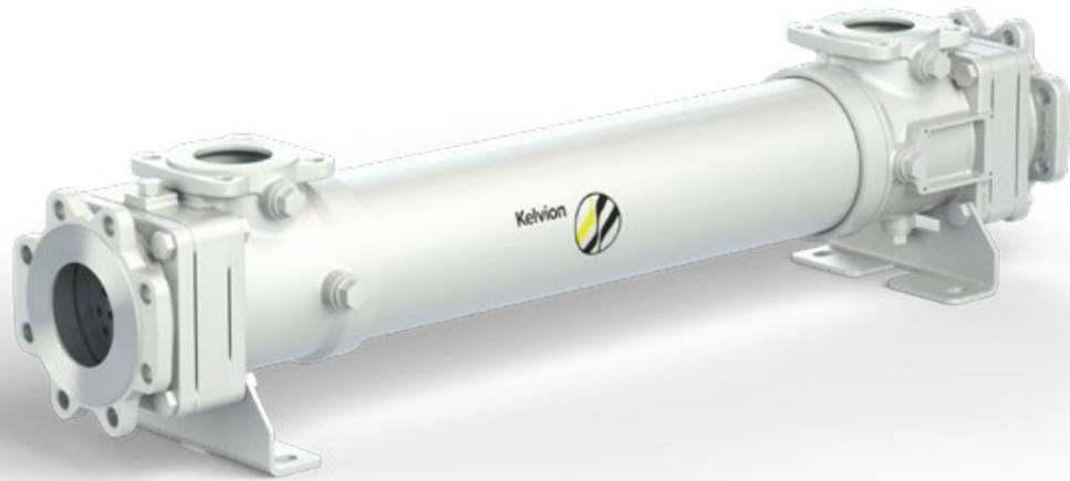
Der standardisierte Doppelrohrsicherheitswärmetauscher ist die kosteneffektive Lösung für niedrige bis mittlere Temperaturen und Drücke. Die modulare Mantelausführung nach AD 2000 ist in Durchmessern von 130 mm bis 280 mm erhältlich und eignet sich für Anwendungen mit Süßwasser, offenem Gewässer und Meerwasser.
